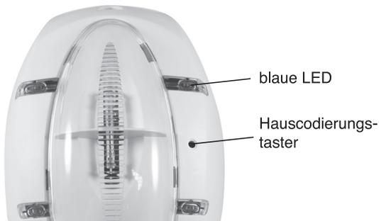
Den Hauscodierungstaster bei anliegender Versorgungsspannung durch das kleine Loch im Gehäuse drücken, bis die blaue LED aufleuchtet. Anschließend loslassen.
